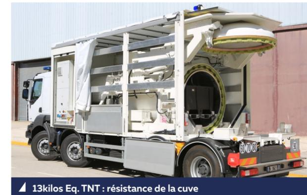
▲ 13kilos Eq. TNT : résistance de la cuve
