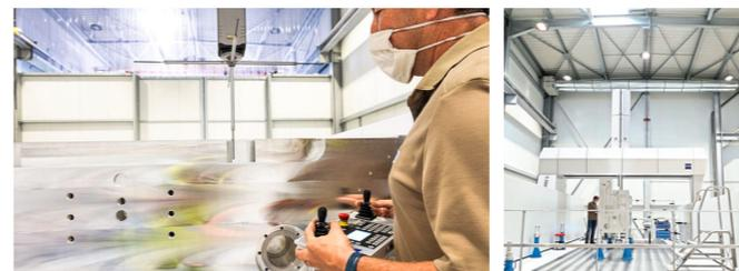
Contrôler au 10<sup>ème</sup> de millimètre près avec la machine ZEISS MMZ-G : (X 4000 X Y 8000 X Z 2000mm)
