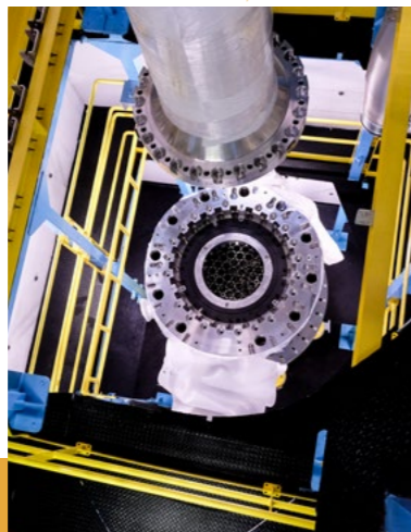
Montage ultra-précis du bloc pile du réacteur Jules Horowitz dans les ateliers de CSI
